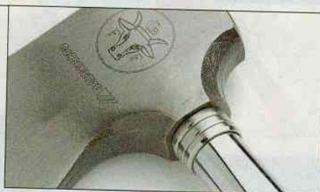
Eine Rohrverankerung müsste eigentlich mit einem Splint gesichert werden – allerdings ist die gemessene Abziehkraft extrem groß
