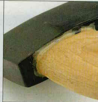
Stand der Technik: Beilköpfe werden heute in der Regel zusätzlich verklebt – meist allerdings etwas schöner als hier bei Alpha Tools
