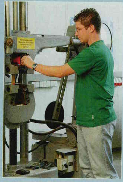
In Abziehversuchen wurde die Stabilität der Werkzeuge gemessen
