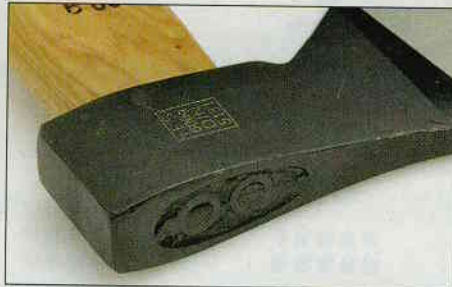
Einige Beile weisen mehrere Metallsicherungen auf. Für die Stabilität ist jedoch eher die fachgerechte Verankerung der Sicherung entscheidend
