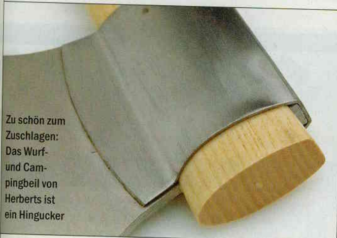
Stand der Technik: Beilköpfe werden heute in der Regel zusätzlich verklebt – meist allerdings etwas schöner als hier bei Alpha Tools
