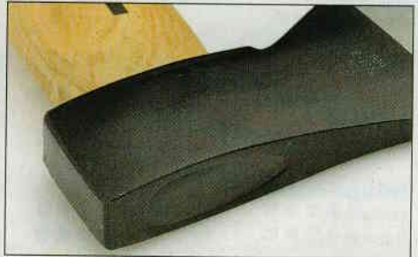
Ein ungutes Gefühl entsteht bei solchen verdeckten Sicherungen – hier bei Budget. Im Test zeigte sich jedoch eine ausreichende Sicherheitsreserve
