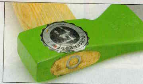
Klassische Beile mit Holzstiel werden mit Keilen aus Holz, Metall oder Kunststoff gesichert – oft aus einer Kombination dieser Materialien
