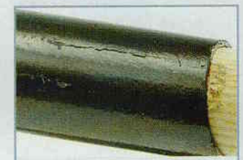
Materialriss an der Flora Tec-Dülle
