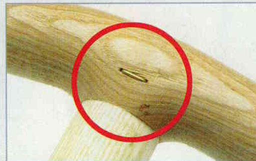
Funktionell in Ordnung, aber optisch unzureichend: Einfache Klammerverbindung an einigen Griffstücken
