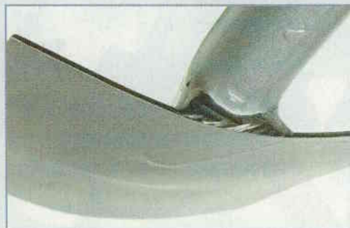
Einige Schweißverbindungen wirken unschön, zudem ist hier recht schneller Rostbefall zu erwarten
