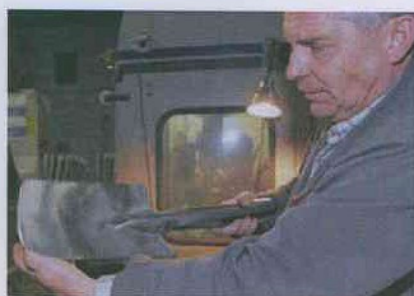
Aus einem Stück werden die Spatenblätter in Witten-Herdecke gewalzt. Nachdem die Blätter maschinell poliert wurden, unterzieht sie Udo Steinbrecher einer strengen Kontrolle.
