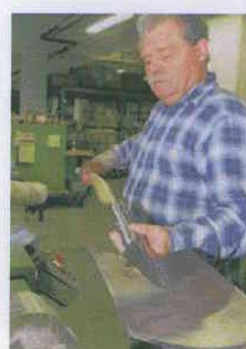
Dr. Bodo Reinke: Das Blatt und der Schaft der Spaten aus Herdecke werden aus einem Stück geschmiedet. Der Stiel des Spatens reicht bis in den Grund und verleiht dem Gartengerät besonders viel Halt.
