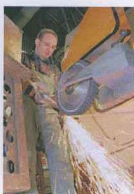
Aus einem Stück werden die Spatenblätter in Witten-Herdecke gewalzt. Nachdem die Blätter maschinell poliert wurden, unterzieht sie Udo Steinbrecher einer strengen Kontrolle.
